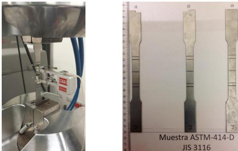
**Figura 1.** Equipo y probetas utilizadas en los ensayos de tracción.
