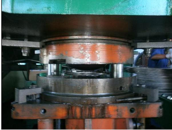
**Figura 6.** Proceso de embutido a escala industrial
