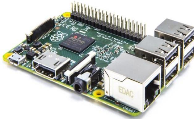
*Figura 2.1: Ordenador de Placa Reducida Raspberry Pi 2 B*
