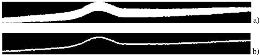
Figura 2.13: a) Sección del haz láser extraído. b) Sección del haz láser adelgazado.
